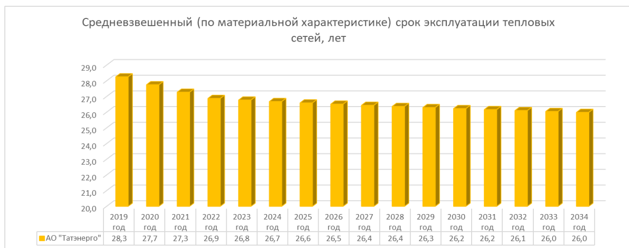
Рис. 1.2 Средневзвешенный (по материальной характеристике) срок эксплуатации тепловых сетей филиала АО «Татэнерго» «Нижекамские тепловые сети»
